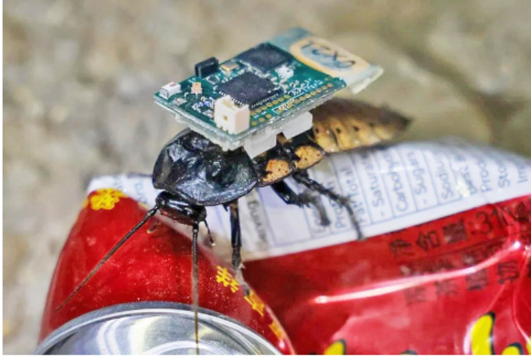
Robot serangga-hibrid yang dilengkapi dengan kamera inframerah dan penerima – menavigasi jalan. – ANN/StraitsTimes
